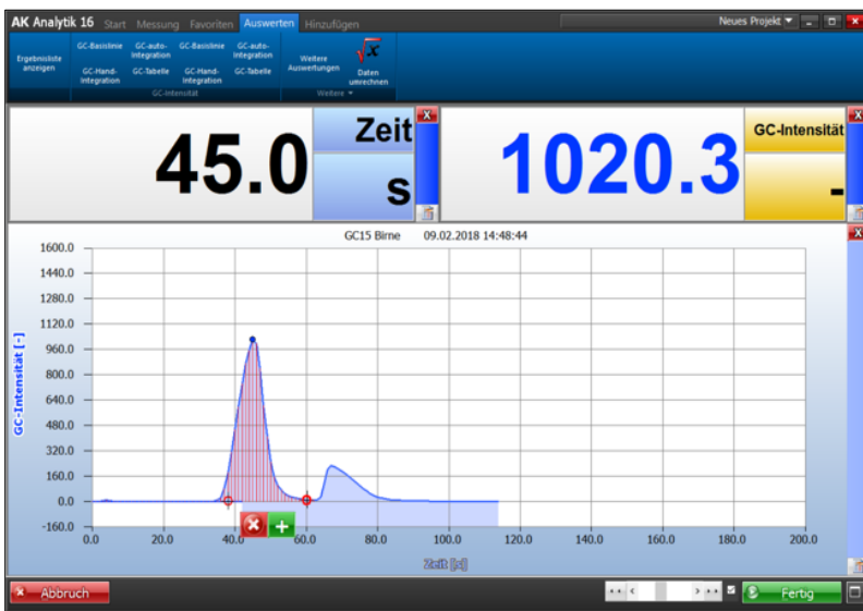
Abbildung 7: Gaschromatogramm des Reaktionsgemischs mit H_2 und CH_4
